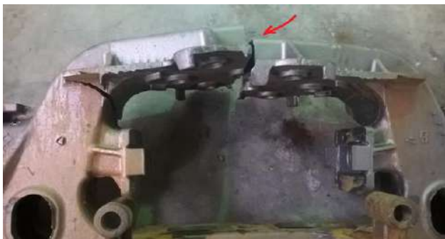
Рисунок 4 – Излом боковой рамы
